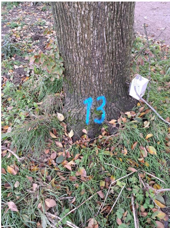
De inclinometer op de stamvoet meet het kiepen van de stamvoet als er kracht wordt uitgeoefend op de boom.
