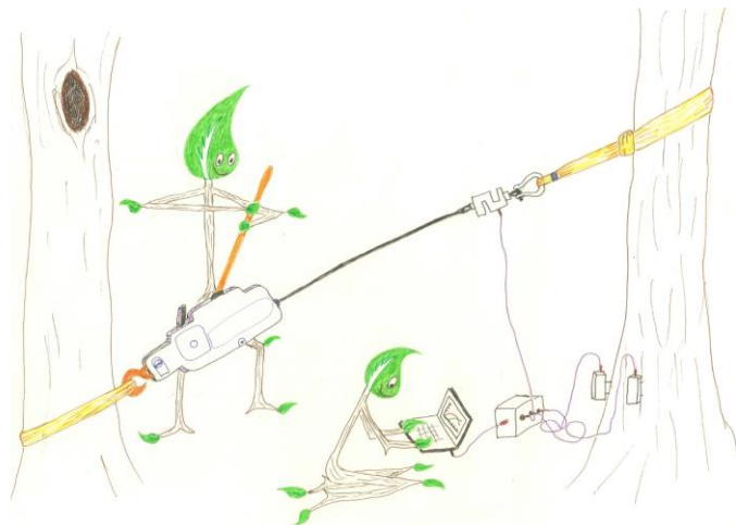
Uitvoering van een trekproef. In dit geval moet mogelijk een zware auto worden gebruikt als ankerpunt in plaats van een buurboom.
