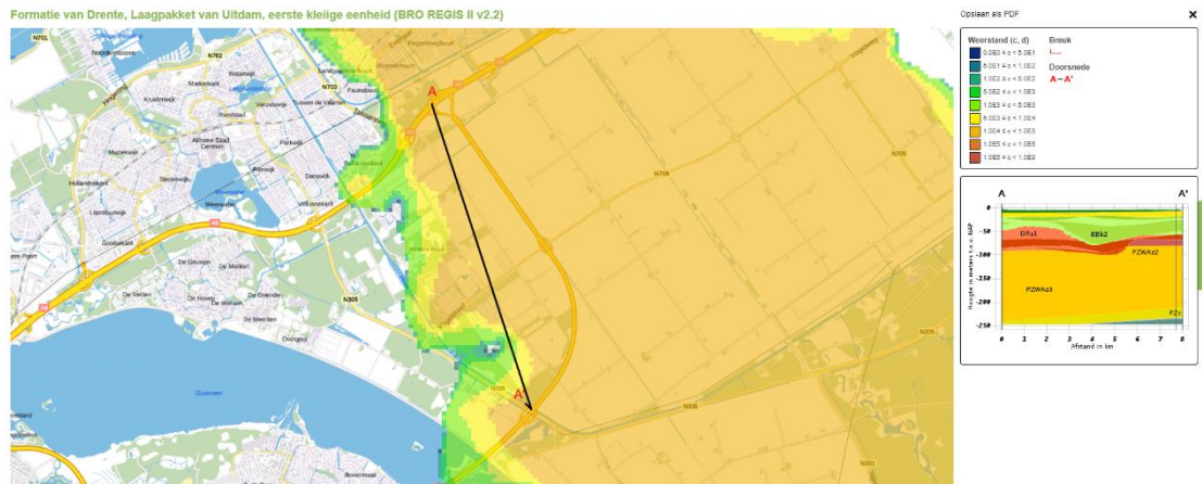
Figuur 2-2 Verbreiding en weerstand van de kleilaag van de Formatie van Drenthe, laagpakket van Uitham. De getekende zwarte lijn geeft de locatie aan van het dwarsprofiel dat rechts in de figuur is weergegeven.
